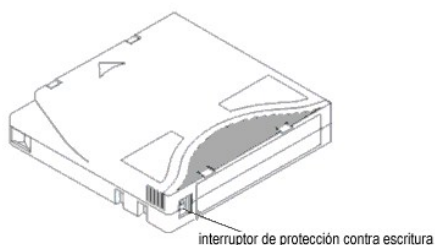
Figura 1. Interruptor de Protección contra escritura en un Cartucho LTO-1
